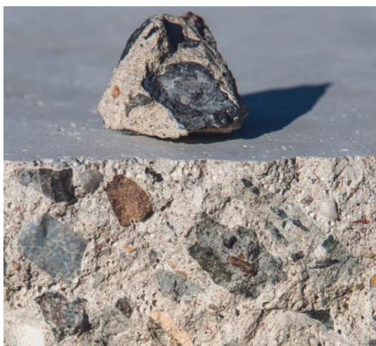
Béton de site - granulats recyclés
